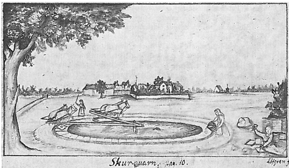
Fig. 4. Skurkvarn på Öland på 1810-talet. På bilden syns en "dubbel" skurkvarn med två bommar, dragen av hästar. Det tycks som en liten familj arbetar tillsammans. Flickan manar på hästarna, mor öser stenringen och far hugger till golvplattorna. Teckning av Nils Isac Löfgren. (ATA/ Vitterhetsakademien.)
