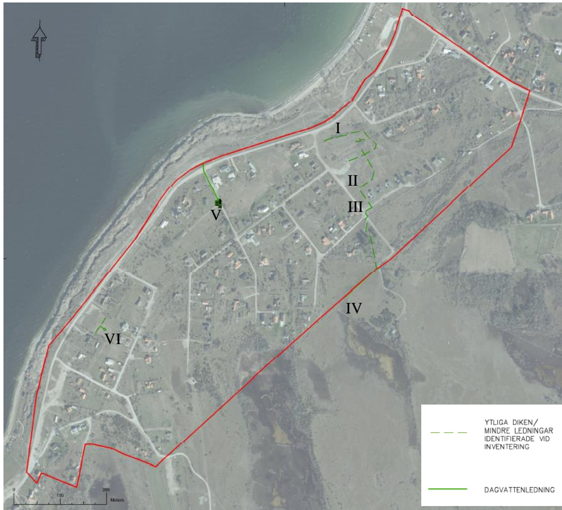
Figur 6: Översikt över planområdet med befintliga dagvattenledningar och diken. Romerska siffror hänvisar till figurer med foton nedan.
